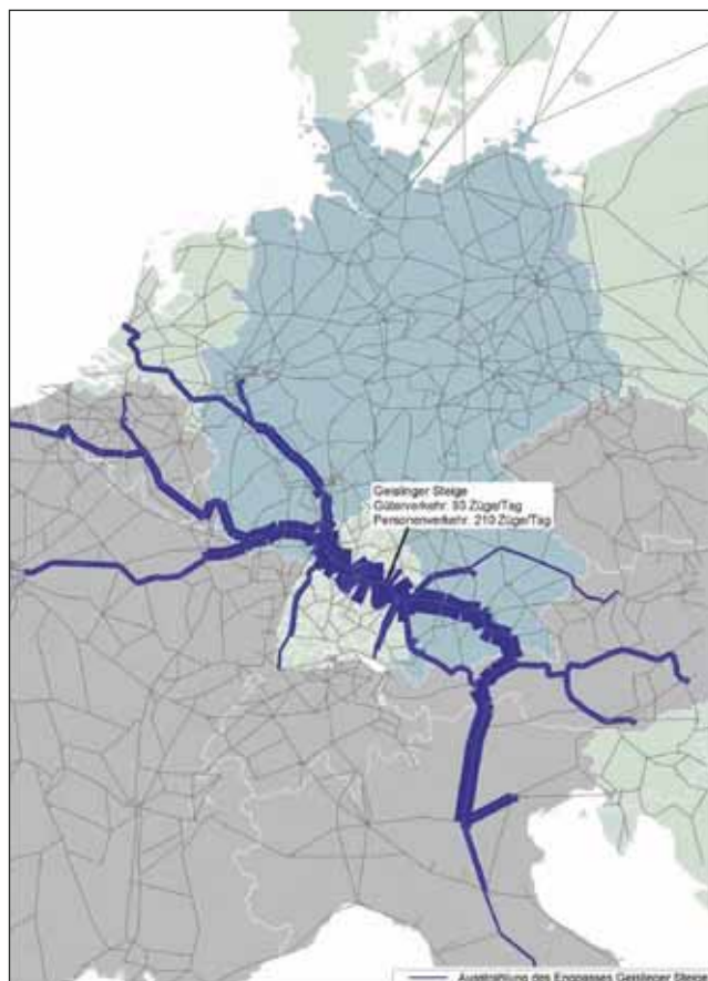
Abb. 4.10: Szenario 1: Ausstrahlung des Engpasses auf der Geislinger Steige (nur Güterzüge dargestellt)
