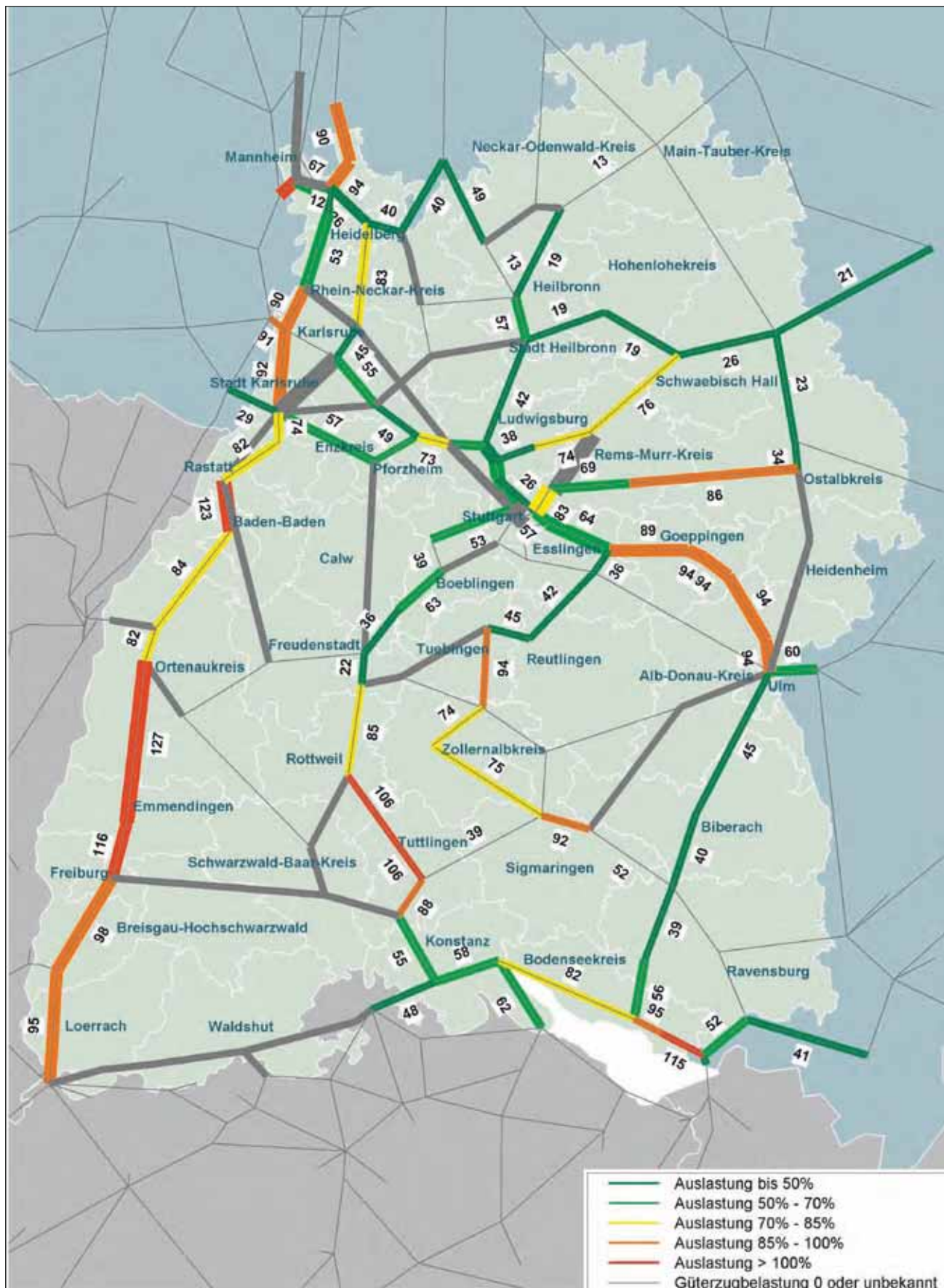
Abb. 4.1: Ist-Situation 2006: Streckenauslastung (Personen- und Güterzüge) auf dem Schienennetz in Baden-Württemberg in Prozent
